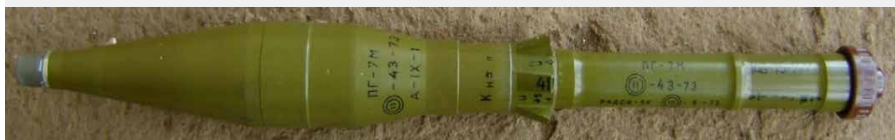
ПГ-7ВМ болгарського виробництва. Зображення © Полі Еванс (Roly Evans)
