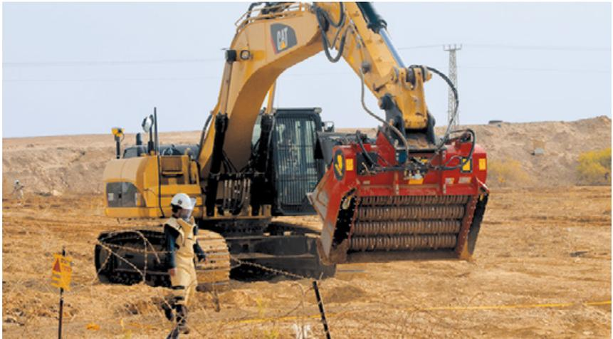
Concasseur mécanique équipé d'un tamis
