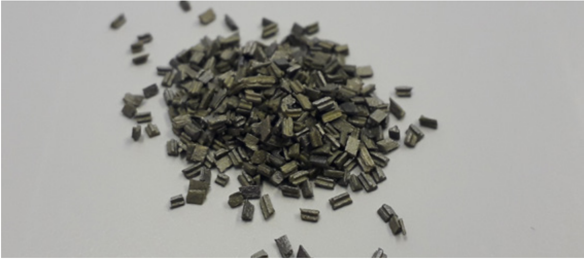
الصورة 19. مادة دفع مصنوعة من النيتروسيلولوز (المصدر: قيادة الدفاع الكيميائي والبيولوجي والإشعاعي والنووي في الجيش الألماني ©)
