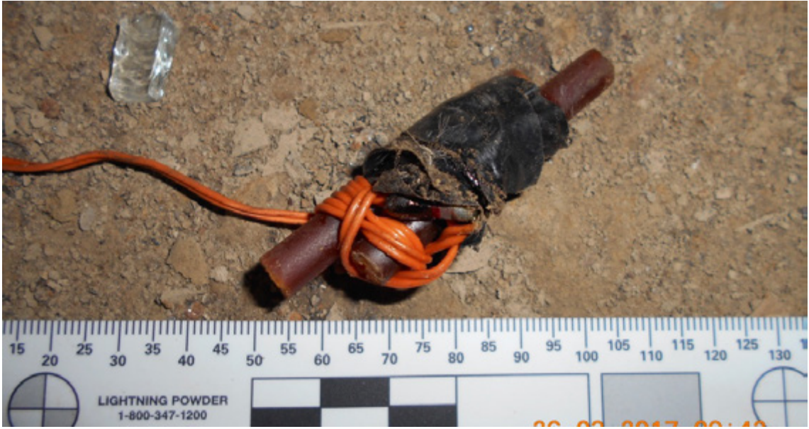
الصورة 190. مثال عن جهاز إشعال صاروخ مبتكر (المصدر: المؤسسة السويسرية لمكافحة الألغام)
