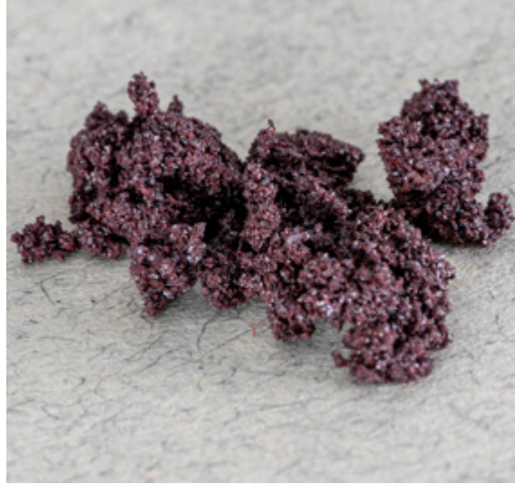
الصورة 89. الفوسفور الأحمر (المصدر: قيادة الدفاع الكيميائي والبيولوجي والإشعاعي والنووي في الجيش الألماني ©)
