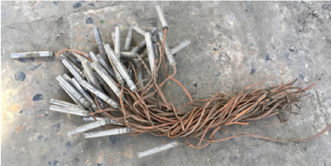
الصورة 13. كبسولات تفجير كهربائية مبتكرة تحوي متفجرات أولية (المصدر: المؤسسة السويسرية لنزع الألغام ©)
