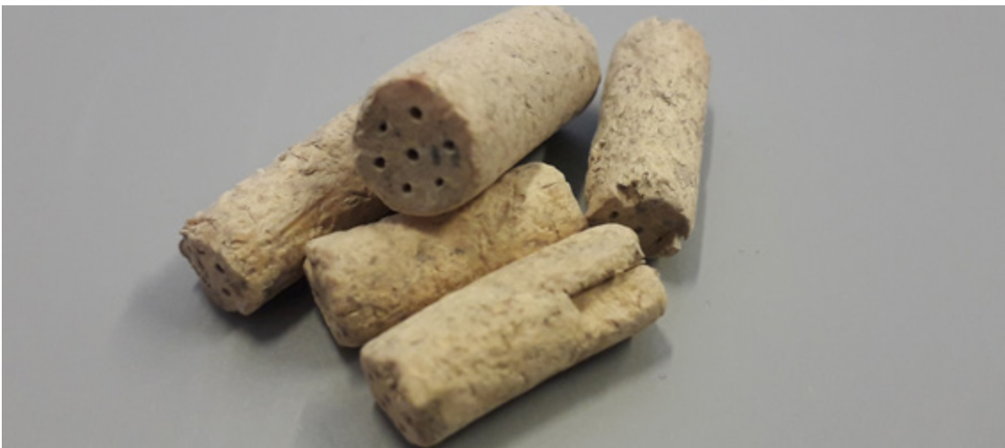
الصورة 20: مثال آخر عن مادة دفع مصنوعة من النيتروسيلولوز. يزيد حفر الثقوب من مساحة الحبيبات، وبالتالي، من الاحتراق. (المصدر: قيادة الدفاع الكيميائي والبيولوجي والإشعاعي والنووي في الجيش الألماني ©)
