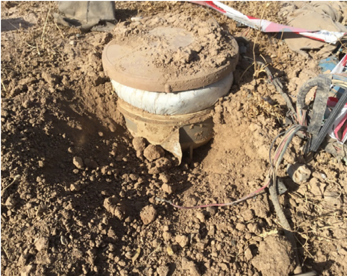
الصورة 12. VS-500 تُظهر توسع المتفجرة اليدوية الصنع نتيجة الرطوبة بفعل مرور الزمن (المصدر: المؤسسة السويسرية لنزع الألغام ©)
