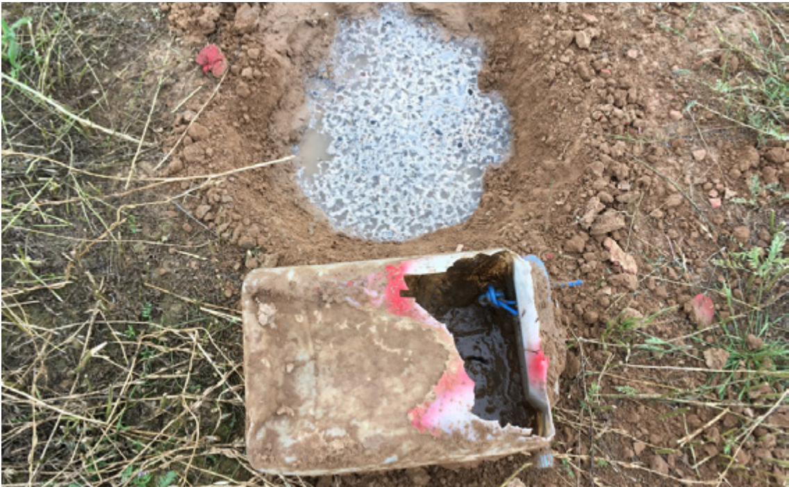
الصورة 117. تأثيرات التقادم: مسحوق الألومنيوم بعد فصلها عن نترات الأمونيوم (المؤسسة السويسرية لمكافحة الألغام)
