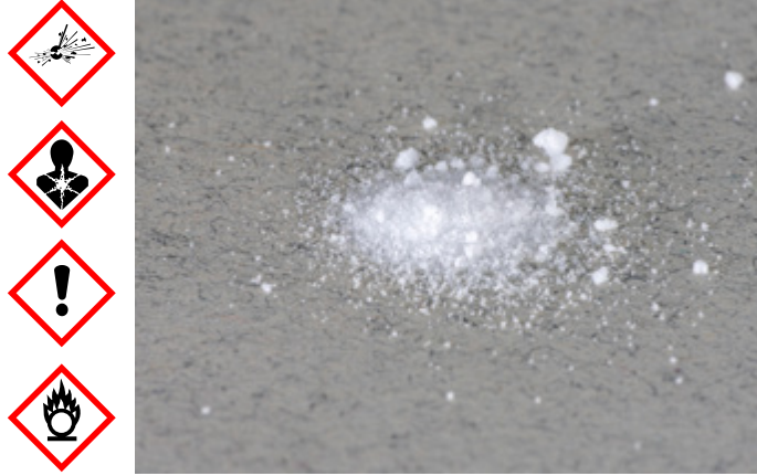
الصورة 48. بيركلورات الأمونيوم (المصدر: قيادة الدفاع الكيميائي والبيولوجي والإشعاعي والنووي في الجيش الألماني ©)
