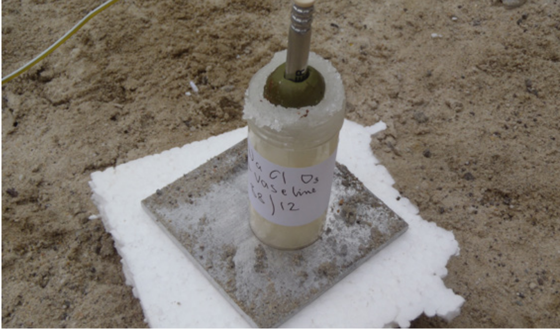
الصورة 133. كلورات الصوديوم - جل البتروليوم، توضّح مظهره المطابق لمظهر بيركلورات البوتاسيوم - جل البتروليوم (المصدر: شركة بريستون للاستشارات (ش.م.))
