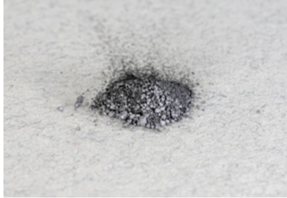
الصورة 146. نترات الأمونيوم والفحم المسحوق (المصدر: قيادة الدفاع الكيميائي والبيولوجي والإشعاعي والنووي في الجيش الألماني ©)
