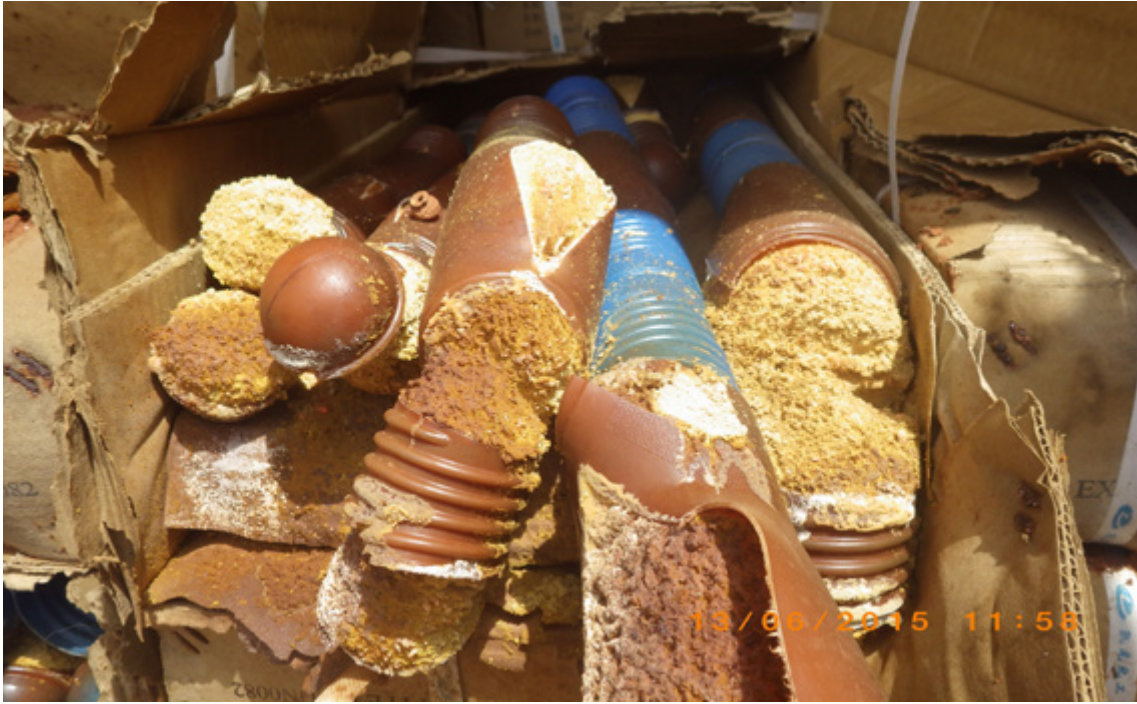
الصورة 118. التقادم: لغم متفجر غير معروف متقادم بعد تخزينه في حاوية غير مكيّفة الهواء في موقع استوائي لمدة زمنية غير معروفة. ويمكن ملاحظة أنّ الغلاف تالف وأنّ لون المتفجر قد تغيّر. لا يمكن تقدير التأثيرات الكيميائية للتقادم على المتفجر (المصدر: ستانيسلاف دامجانوفيك)
