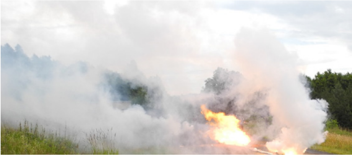
الصورة 18. مثال عن سلوك حرق لمواد الدفع الصلبة عندما لا تكون محصورة (المصدر: مركز جنيف الدولي لأنشطة إزالة الألغام للأغراض الإنسانية ©)
