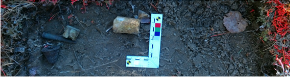
الصورة 2. مثال على مركب متفجر متجانس: ثالث نترت التولوين (TNT) (مُسْتَعْمَل هنا كحشوة للقذائف المدفعية) (المصدر: مركز جنيف الدولي لأنشطة إزالة الألغام للأغراض الإنسانية © GICHD)
