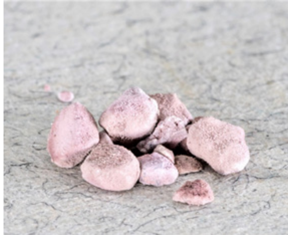
الصورة 193. أزيد الرصاص الناتج عن رد فعل سريع للغاية أدى إلى تحوّل البلّورات الصغيرة إلى قطع مرئية. إنّ الصبغة الوردية غير شائعة. (المصدر: قيادة الدفاع الكيميائي والبيولوجي والإشعاعي والنووي في الجيش الألماني ©)
