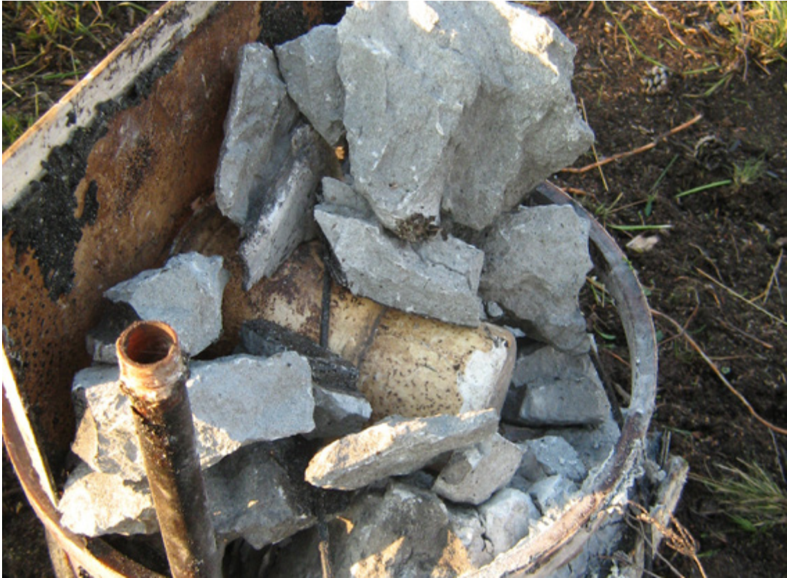
الصورة 4. مثال عن متفجرة عسكرية: مخلفات رأس حربيّ لطوربيد مُعبأ بالتوربيكس (هيكسوجين، وثالث نترت التولوين (TNT)، ومسحوق الألومنيوم، وشمع) (المصدر: مركز جنيف الدولي لأنشطة إزالة الألغام للأغراض الإنسانية ©)
