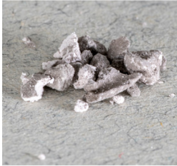
الصورة 197. أسيتيليد الفضة (المصدر: قيادة الدفاع الكيميائي والبيولوجي والإشعاعي والنووي في الجيش الألماني ©)
