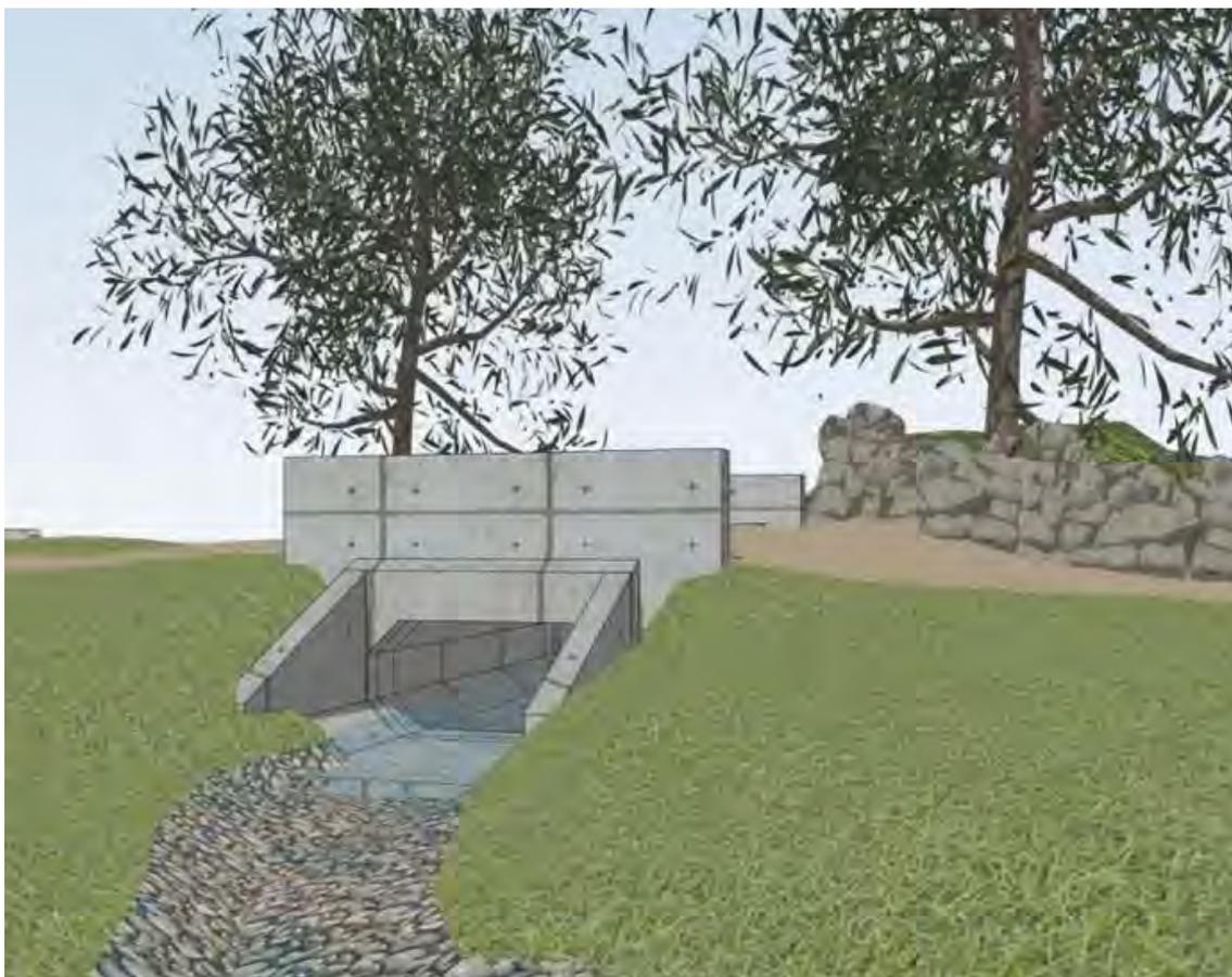
Рисунок 23. В водопропускных трубах можно устанавливать СВУ
